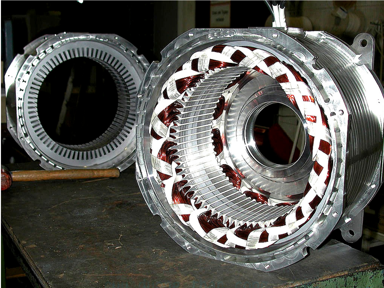
HÌNH 5.8: Dây quấn stator sau khi quấn hoàn chỉnh.
